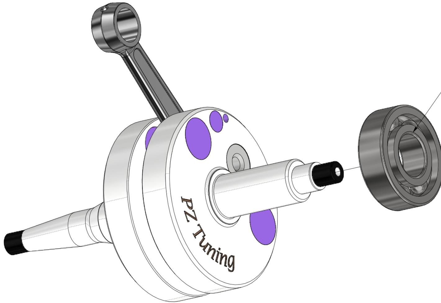
1. Innenring von Lager 6204 erwärmen *nicht über 100C°* und Kurbelwellenlager auf Kurbelwelle setzen
